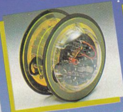
CIRCULAR MV-935 È provvisto di due grandi ruote che gli permettono di ruotare in avanti, a destra, a sinistra e su se stesso. Tutti i movimenti sono controllati mediante un comando a distanza.
